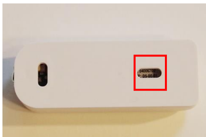
写真 小窓からのミニセンサーの EEP と ID 確認
